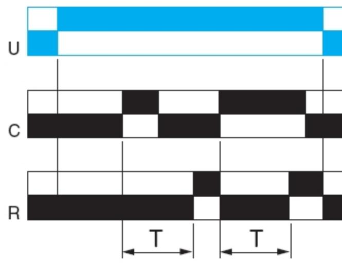
После подачи питания на реле времени, а затем импульса или непрерывно напряжения на управляемый вход С начинается отсчет выдержки времени Т. По окончании выдержки времени Т выход R замыкается. Выход R возвращается в исходное состояние следующей подачей импульса или постоянно напряжения на управляемый вход С.
